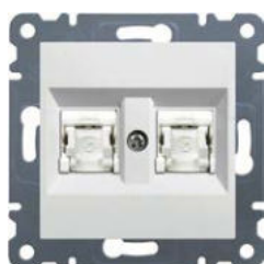
Zásuvka datová, 2x RJ 45, 8/8 pólová, UTP, Cat.5e
