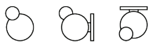
Thumb turn on rose (knob Ø 30 mm, rose Ø 50 mm) Bouton de condamnation sur rosace
