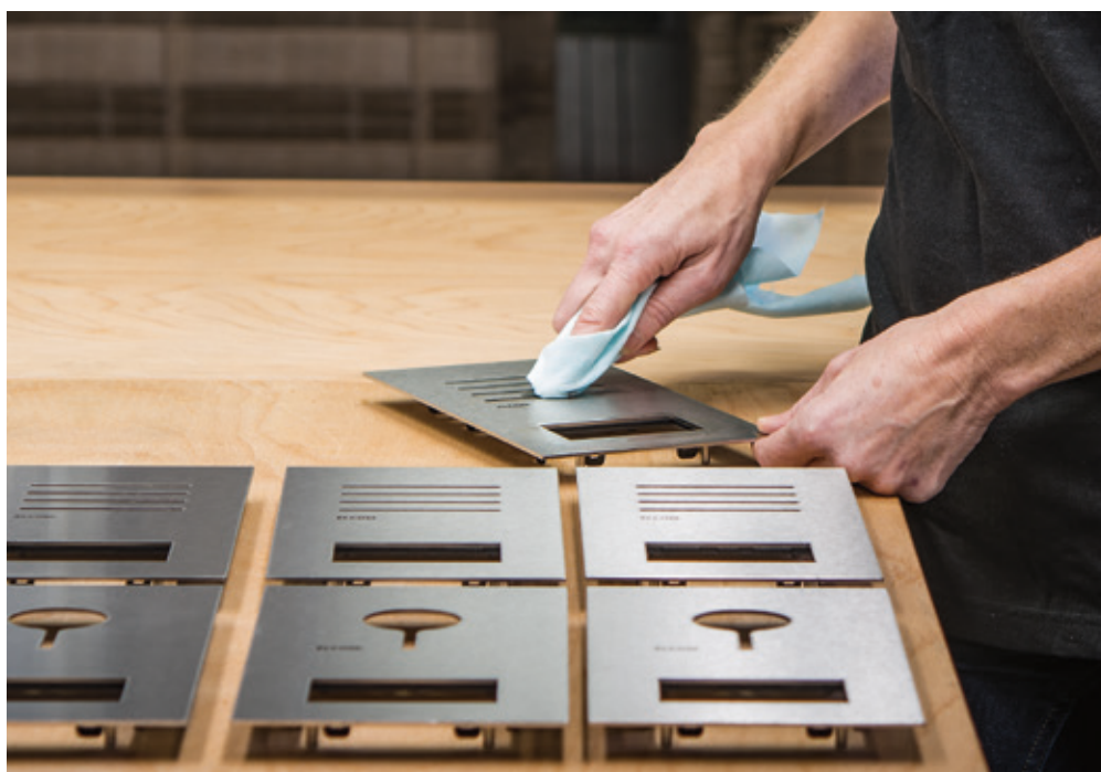
Abb.: Frontblenden von Elcom nach der Laserung.
